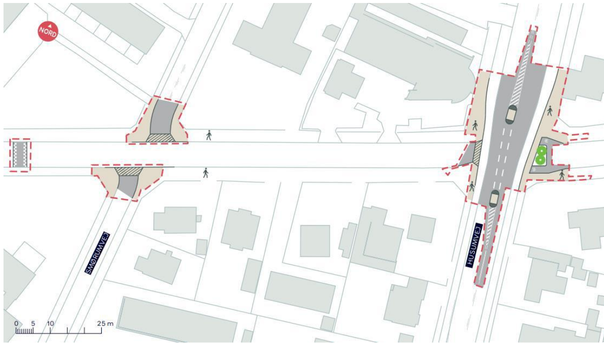
Figur 1 Spærring, overkørsler og bump på Korsager Allé
